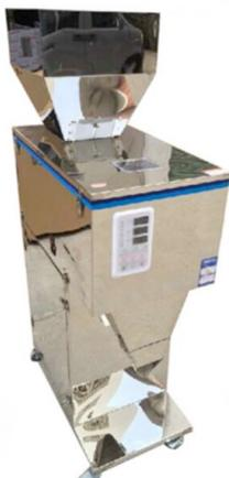
**IL DOSATORE PRESENTA UN SISTEMA UNICO DI REGOLAZIONE DELLE VIBRAZIONI, PERMETTENDO DOSARE I VARI PRODOTTI GRANULARI, E MANTENERE UNA COSTANTE PRECISA, TRA VELOCITA' E PRECISIONE.**
